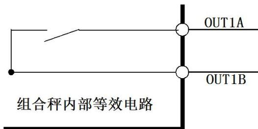
2、给组合秤的输入信号建议用继电器的常开触点连接，如下图：
